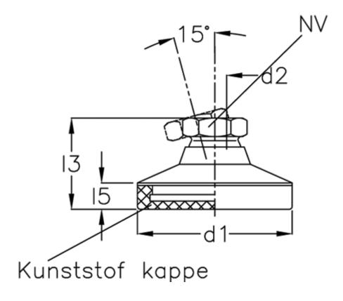
d1 = 60 d2 = 12 l3 = 37.5 l5 = 10 NV = 17 Static load (N) = 16 t min = 11.5
